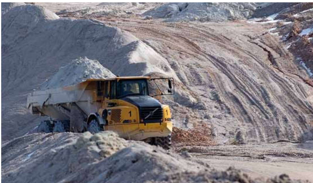
Tagebau bei Dorfner zum selektiven Abbau von kaolinhaltiger Roherde
