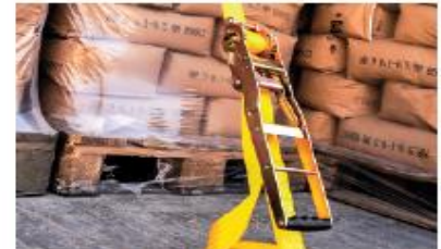
Geeignete Spannratschen (Vorspannung 500 daN)
