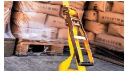
Geeignete Spannratschen (Vorspannung 500 daN)
