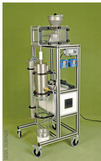
Apparatur am IGF zur Staubmessung im Gegenstrom-Fallrohr.
