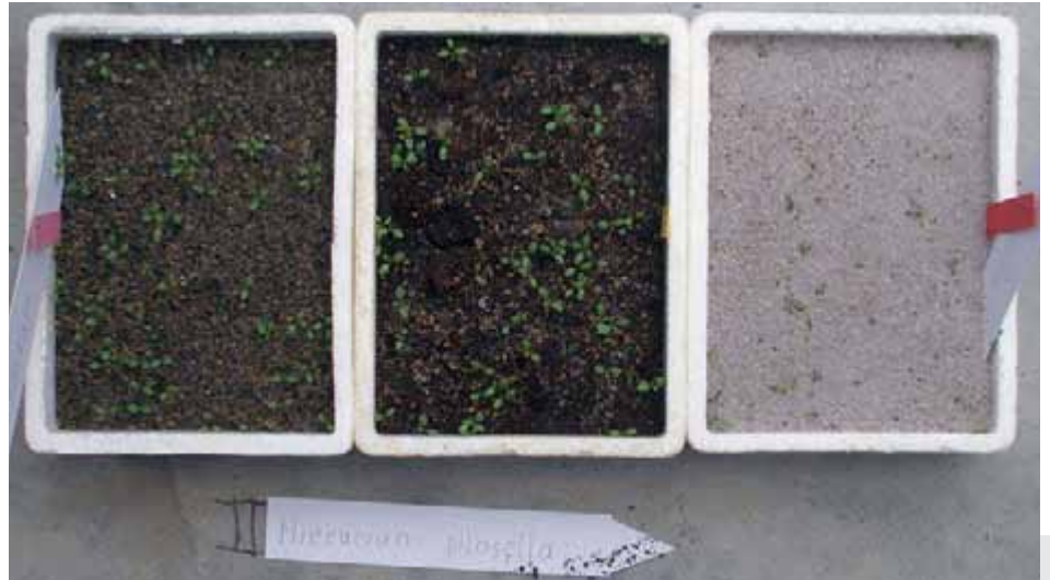
Bild 3: Saatschalen mit Hieracium pilosella (kleines Habichtskraut) v.l. auf Brechsand, Torf-Kultur-Substrat und Dorfner Fugensand+ (Aufnahme 13.01.2010 – 21 Tage nach Ansaat)
