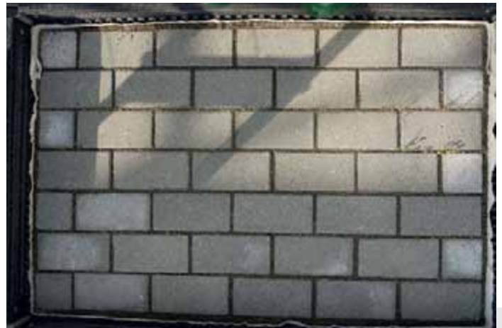
Bild 7: Auf Brechsand können sich dagegen selbst in der trockenen Variante einige Sämlinge ansiedeln (Aufnahme 21.04.2010, Palette 41)
