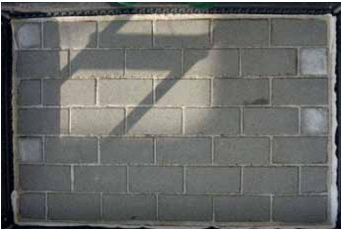
Bild 6: In der trockenen Variante bleiben die Parzellen mit Dorfner Fugensand+ beinahe vegetationsfrei (Aufnahme 21.04.2010, Palette 42)
