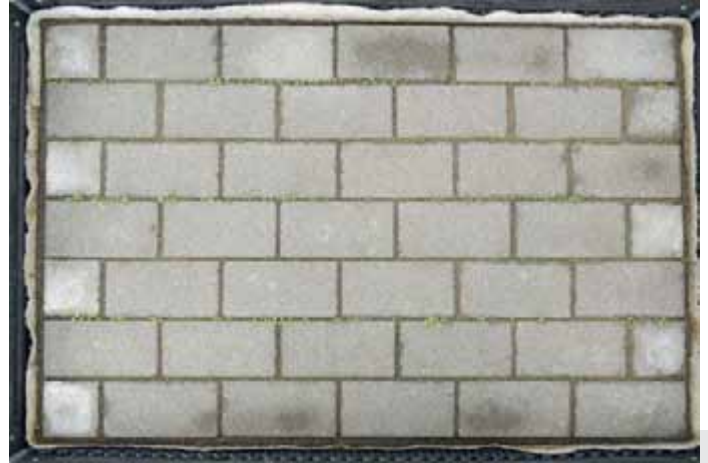
Bild 5: Auf gealtertem Brechsand sind die Pflanzen dagegen unter feuchten Bedingungen größer und kräftiger (Aufnahme 27.05.2010 Palette 17)
