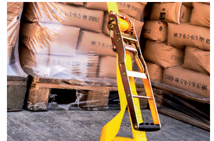
Geeignete Spannratschen (Vorspannung 500 daN)
