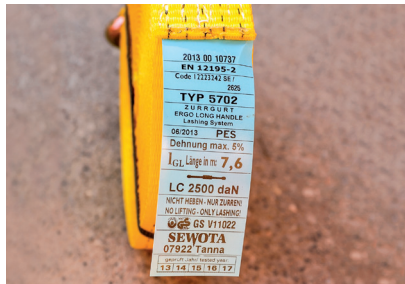
Geeignete Spanngurte (2.500 daN mit blauem Typenschild)
